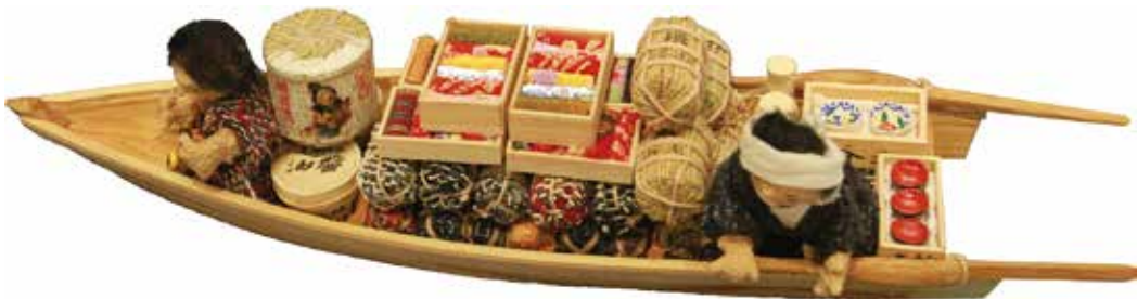
伝馬船が下り荷を運ぶ様子。伝馬船は北前船に搭載されている船で、轆轤 るくろ で帆桁 てんません をクレーンのように操作して積み降ろしする。沖に停泊した船と岸を連絡した。
