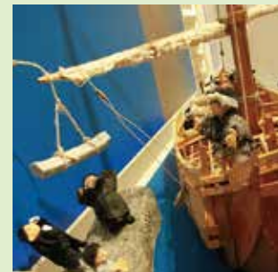
↑帆桁には、船体内部の轆轤を回すことで、伝馬船や石材などの重量物を昇降させる役割もあつた。
