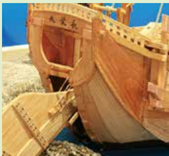
↑和船の大きな特徴である跳ね上げ式の舵。港灣未整備時代の海運を支えたが、外艫と共に強度的な難点があり、海難の原因になった。
